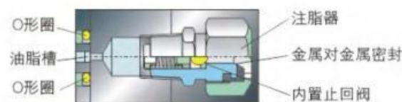
图 5. 阀杆注脂及带压更换注脂器设计
